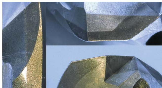
Schneidkantenzustand nach 120 Bohrungen
